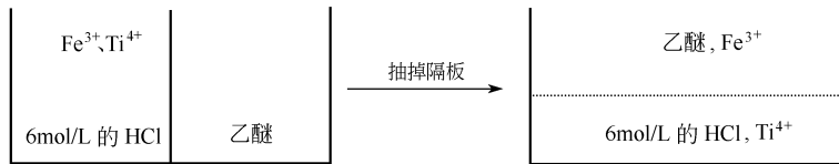
图 1-2 非均相体系中 \text{Fe}^{3+} 和 \text{Ti}^{4+} 的混合实验
